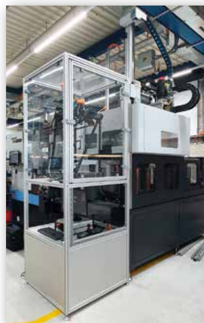
Cellule de mesure avec Correcteur d'outil intéraction complète
